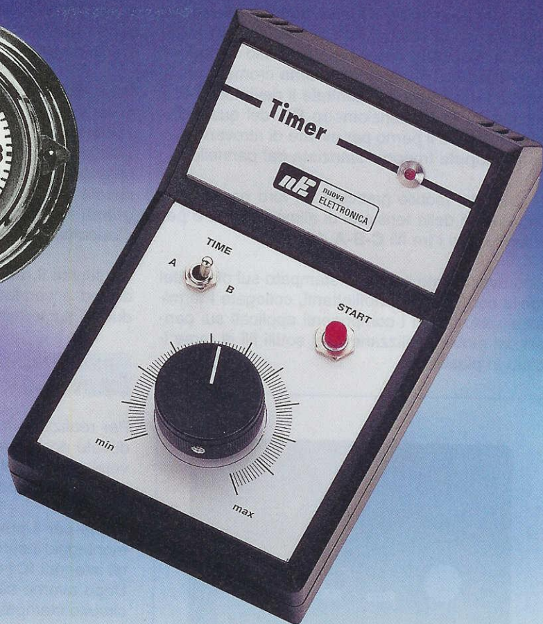
Fig.491 Ecco come si presentano i due temporizzatori dopo aver fissato sul coperchio del mobile il potenziometro, il deviatore, il pulsante e il diodo led. I pannelli di alluminio vanno fissati sul coperchio del mobile con un po' di collante cementatutto.
