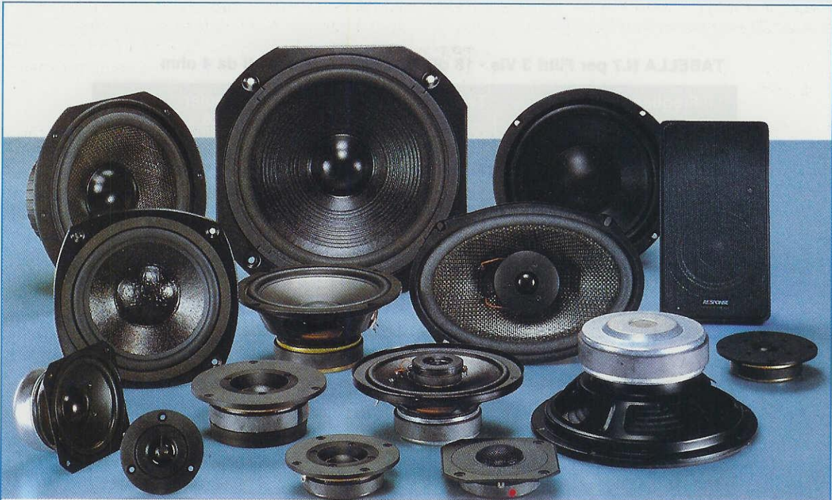
Fig.16 Gli altoparlanti chiamati Woofers , che risultano idonei a riprodurre fedelmente tutte le frequenze dei Bassi e Medio-Bassi, hanno un diametro elevato. Quelli chiamati Midrange , che hanno un diametro minore, risultano idonei a riprodurre le sole frequenze dei Medi o Medio-Acuti, mentre quelli chiamati Tweeter , che hanno un diametro molto piccolo, risultano idonei a riprodurre le sole frequenze degli Acuti o Super Acuti.
