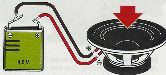
Fig.17 Sulle uscite di ogni filtro sono riportati i simboli +/- che vi permettono di mettere in fase gli altoparlanti.
