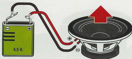
Fig.17 Sulle uscite di ogni filtro sono riportati i simboli +/- che vi permettono di mettere in fase gli altoparlanti.
